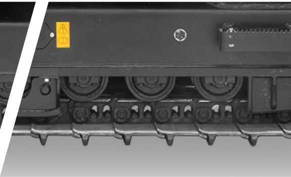
Carters de protection des rouleaux et roue motrice du chenillard
