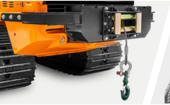
Treuil arrière, capacité 13 tonnes
