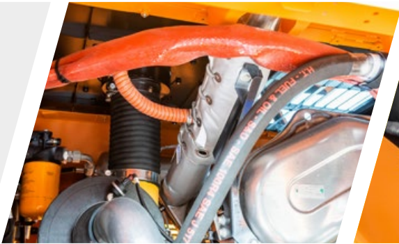
Filtration avec éjecteur pour tâches exigeantes
