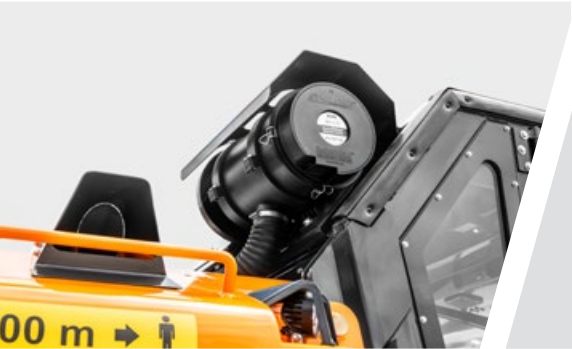
Système de pressurisation de la cabine
