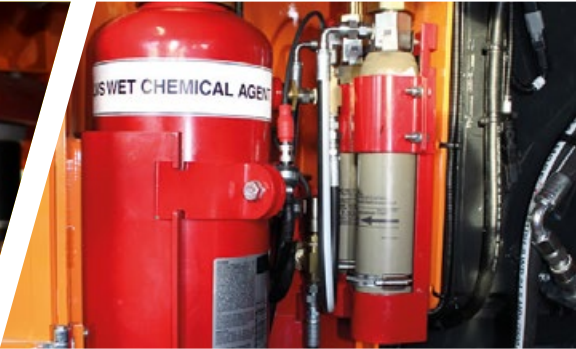
Système anti-incendie automatique
