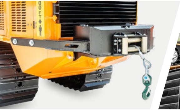
Treuil arrière, capacité 6 tonnes
