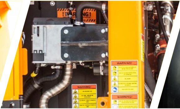
Système de préchauffage moteur et huile hydraulique
