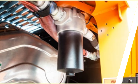
Sistema filtrazione per impegni gravosi (drenaggi)
