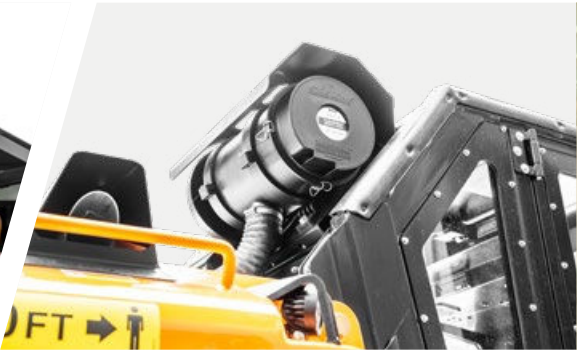
Système de pressurisation de la cabine
