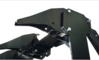
Dents ripper aident l'alignement des arbres à broyer qui, une fois abattus, peuvent être rassemblés pour le broyage final
