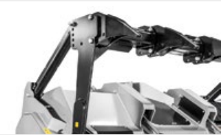
Rabatteur hydraulique pousse et canalise le matériau avant le broyage
