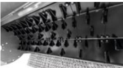
Contre-couteaux Spike Pro les contre-couteaux Spike Pro et leur distribution garantissent une meilleure finition du matériau
