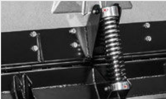
Bandes de nivellement sur porte arrière amorties pour niveler la matière brisée, créant ainsi une base uniforme
