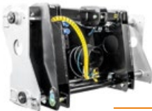
Déplacement latéral hydraulique permet au broyeur de se déplacer avec agilité, rapidité et précision et de travailler près des plantes et des cultures sans les endommager
