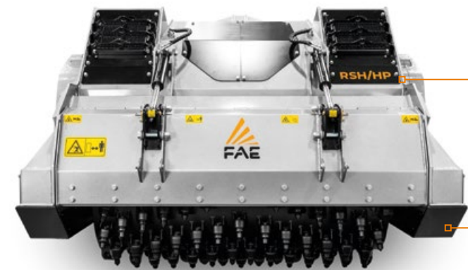
Réducteurs latéraux et boîte d'engrenages centrale avec système de refroidissement de l'huile maintien d'une productivité et d'une efficacité maximales dans toutes les conditions de travail
